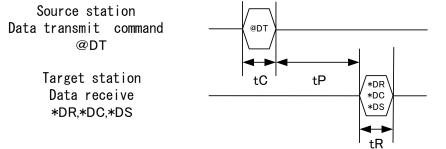
\*Reference value with 40-byte TX. tC=(40+7)\*10000/9600=49ms tP=(40\*2.08)+46=130ms (standard) (tP=(40\*2.08)+124=208ms (FEC)) tR=(40+8)\*10000/9600=50ms Total=49+130(208)+50=229(307)ms
